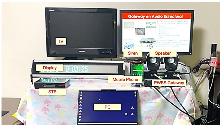
図 6 中南米向けに技術開発した EWBS システム
