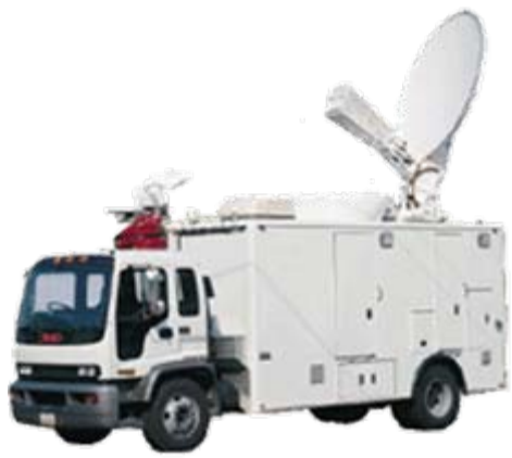
衛星中継車による素材伝送 当社が回線割当を行いTV 局が運用 放送局SNG局
