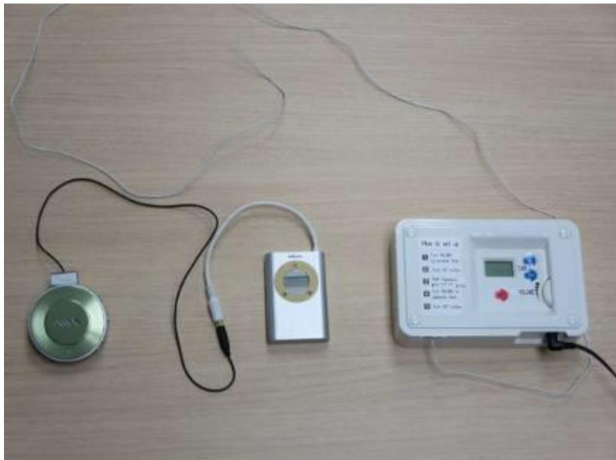
図 2.5 微弱 FM 波による緊急警報放送のデモンストレーション
