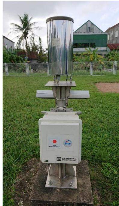
図 6. 雨量自動計測機
