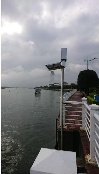
図 5. 河川水位自動計測機
